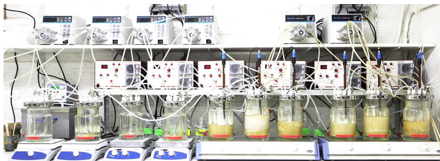
Figura 1: SHIME - Simulador de vários estágios do sistema digestivo humano
